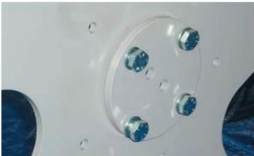
*INSERTE EL DISCO DE FIJACIÓN DE LAS PALAS EN LA ESTRELLA POR MEDIO DE TORNILLOS*
