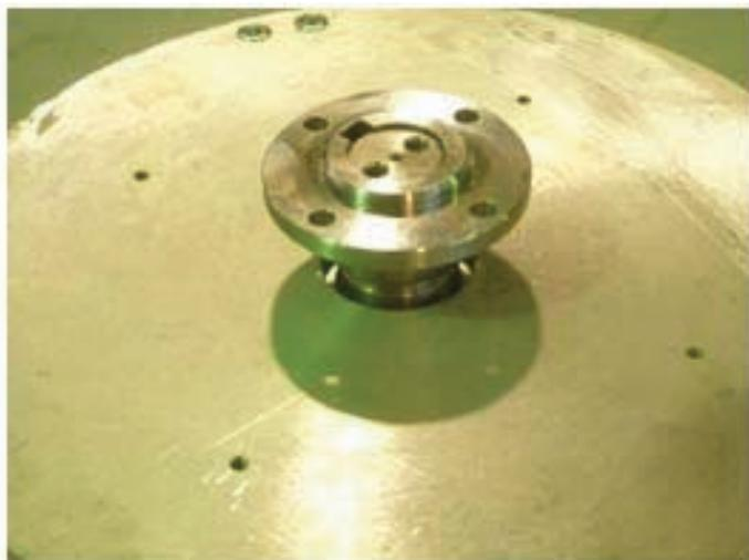
***UNA VEZ EXTRAÍDA LA ESTRELLA DESMONTE EL CUBO DEL EJE***
