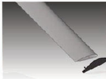
*Desenrosque el tornillo que fija el terminal de plástico a la pala*
